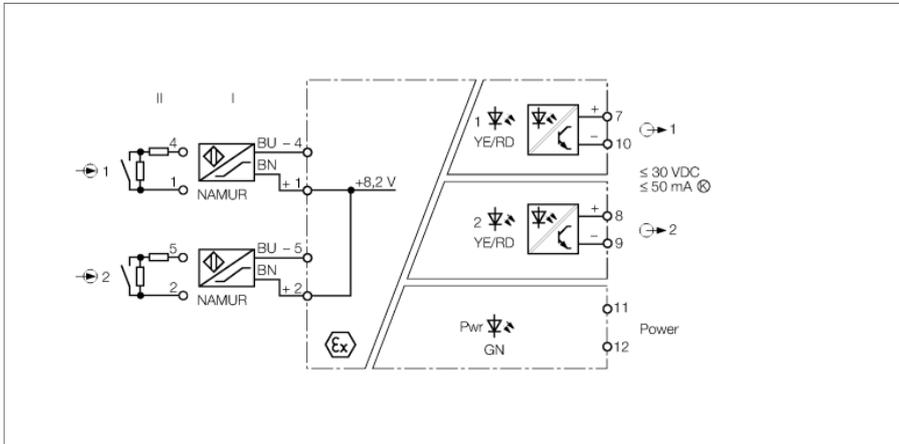
Der 2-kanalige Trennschaltverstärker vom Typ IM1-22EX-T ist mit eigensicheren Eingangskreisen ausgestattet.
