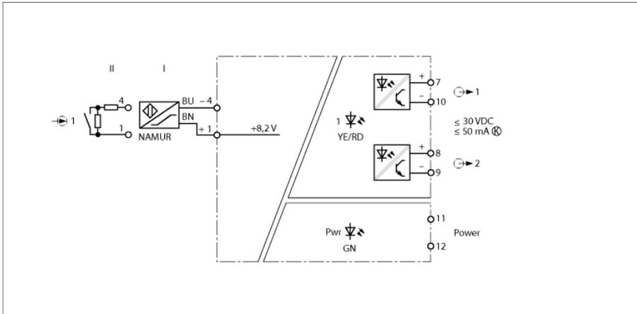
Der Trennschaltverstärker vom Typ IM1-12-T ist 1-kanalig ausgeführt.
