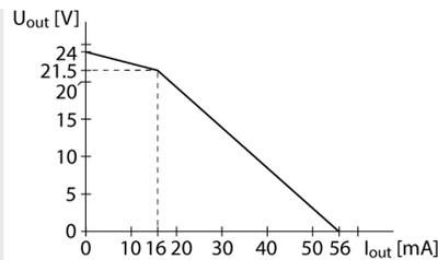
Sammelstörmeldeausgang Power-Bridge MOSFET,  $U_{max}=30$  V,  $I_{max}=100$  mA
