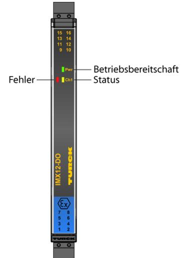
Der 1-kanalige Ventil-Steuerbaustein vom Typ IMX12-DO01-1U-1U-PR/24VDC/CC stellt ein in Strom und Spannung begrenztes, eigensicheres Ausgangssignal bereit. Somit können Verbraucher im explosionsgefährdeten Bereich direkt angesprochen werden. Typische Anwendungen sind das Ansteuern von Ex i-Pilotventilen, das Versorgen von Anzeigen und die Versorgung von Transmittern. Das Gerät kann über eine Power-Bridge versorgt werden, die auch eine Sammelstörmeldung überträgt.
