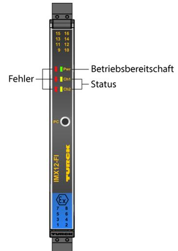
Der Frequenzmessumformer/Puls-Counter IMX12-FI01-2SF-2I-C/24VDC/CC ist mit eigensicheren Eingangskreisen ausgestattet und überträgt Frequenzsignale bis 20000 Hz galvanisch getrennt aus dem explosionsgefährdeten Bereich in den sicheren Bereich. Zusätzlich können die Eingangssignale auf Schlupf überwacht werden. Die Geräte sind für den Betrieb in Zone 2 geeignet.
