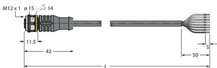
Cable de conexión, conector hembra M12, recto, de 8 polos, longitud del cable: 2 m; material de revestimiento: PUR, negro; aprobación cULus
