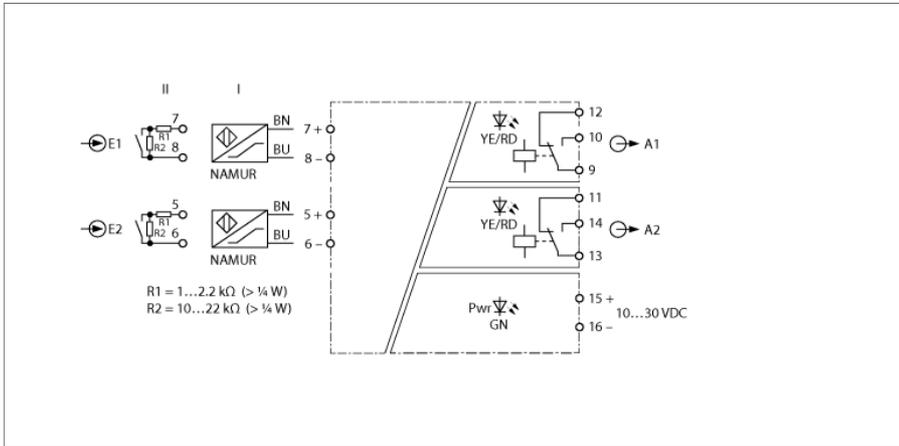
En el amplificador-separador IM12-DI01-2S-2R-0/24VCC se puede conectar sensores conforme a la EN 60947-5-6 (NAMUR) o contactos sin potencial. El dispositivo se puede instalar en la zona 2 y, mediante un interruptor DIP, el equipo puede conmutarse entre el funcionamiento de 2 canales o el funcionamiento de 1 canal con duplicación de señal. Los circuitos de salida están equipados con dos relés de conmutación. El dispositivo cumple los requisitos de la norma NE21.
