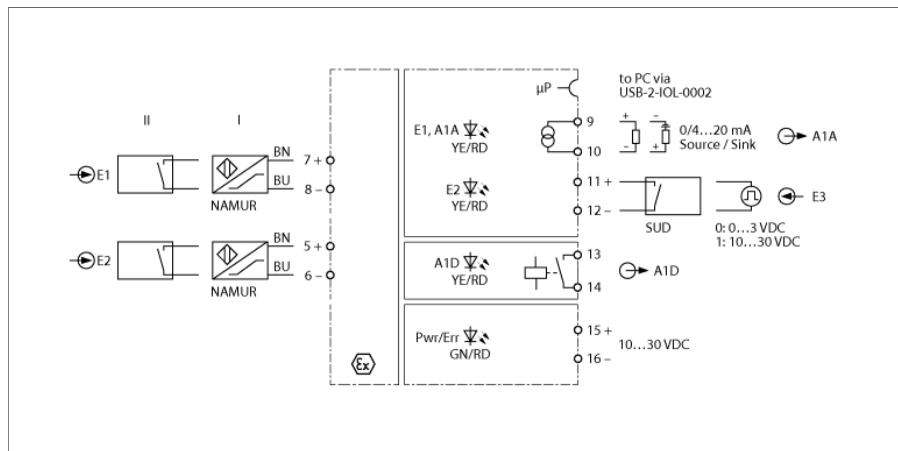
El transductor de frecuencia/contador de impulsos IMX12-FI01-1SF-1I1R-C0/24 VCC/CC está equipado con circuitos de entrada de seguridad intrínseca y transmite señales de frecuencia de hasta 20 000 Hz aisladas eléctricamente desde la zona en riesgo a la zona segura. Adicionalmente, se pueden supervisar los límites, el deslizamiento o la marcha hacia delante/atrás. Los dispositivos son adecuados para el funcionamiento en la zona 2.
