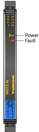
El transductor de aislamiento de 1 canal IMX12-AI01-1I-1IU-H0/24VCC/CC HART® está diseñado para operar de forma intrínsecamente segura transductores de dos hilos HART® en el área Ex y transmitir las señales medidas al área no Ex. Además de las señales analógicas, las señales de comunicación digitales HART® también se pueden transmitir bidireccionalmente. Además, se pueden operar transmisores HART® de dos hilos pasivos y activos.
