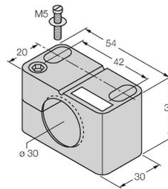
Bride de fixation pour détecteurs à tube fileté, avec butée fixe ; matériau : PA6
