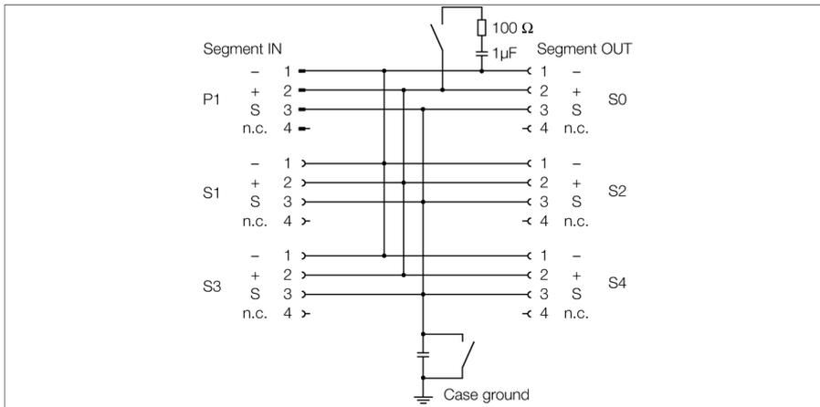
Le répartiteur à quatre canaux du type JBBS-49-E413/3G est conçu pour le FOUNDATION™ fieldbus.
