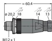
Connecteur mâle confectionnable, M12 x 1, droit, 4 pôles, raccordement par borne à vis, diamètre de ligne 4,0 à 6,0 mm, section conducteur/section raccordable 0,14 à 0,75 mm<sup>2</sup>, boîtier plastique, vis de montage métallique
