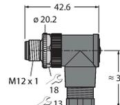
Connecteur confectionnable, M12 x 1, coudé, 4 broches, raccordement par borne à vis, diamètre de ligne de 4,0 à 6,0 mm, section conducteur/section raccordable de 0,14 à 0,75 mm<sup>2</sup>, boîtier plastique, vis de montage métallique
