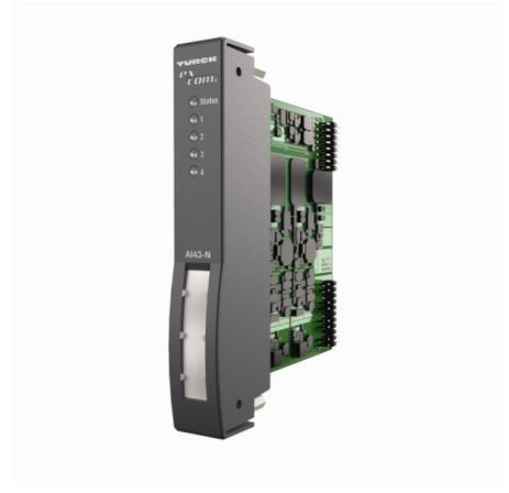
Le module d'entrée analogique AI43-N sert de la connexion de potentiomètres en technique 3 ou 4 fils. En cas d'utilisation de potentiomètres en technique 3 fils, un pontage aux bornes de raccordement à la platine est exigé. Des mesures de résistance, ainsi que l'évaluation de potentiomètres avec raccordement en technique 2 fils ne sont pas possibles.
