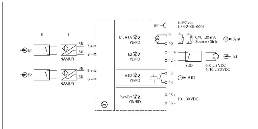
Le convertisseur de mesure de fréquence/Puls-Counter IMX12-FI01-1SF-1I1R-C0/24VDC/CC est équipé de circuits d'entrée à sécurité intrinsèque et transmet des signaux de fréquence jusqu'à 20000 Hz séparés galvaniquement de la zone explosive à la zone sûre. De plus, il est possible de surveiller les valeurs limites, le glissement ou la marche à droite/à gauche. Les appareils sont conçus pour un fonctionnement en zone 2.
