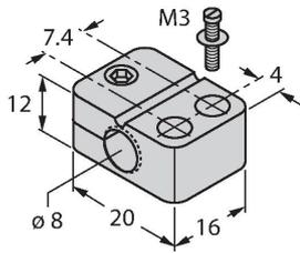
Монтажный зажим для цилиндрических резьбовых датчиков, с упором; материал: ПА6
