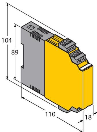
Изолированный переключающий усилитель, 2-канальный; 2 транзисторных выхода; вход для сигналов NAMUR; ВКЛ/ВЫКЛ функции мониторинга обрыва цепи и короткого замыкания; настройка направления сигнала выхода (нормально открытый или нормально закрытый); сменные клеммные блоки, ширина 18 мм; универсальное питание
